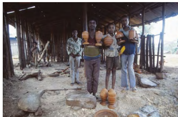
Handsvarvade träkärl. Svarven roterar med hjälp av en rem som dras fram och tillbaka för hand.
